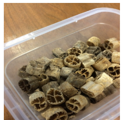
Figuur 2: AHPD Proefinstallatie op EnTranCe en teruggewonnen fosfaat (vgl. struviet)
