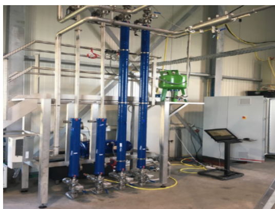
Figuur 2: AHPD Proefinstallatie op EnTranCe en teruggewonnen fosfaat (vgl. struviet)
