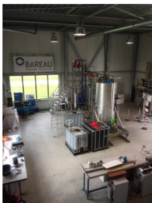
Figuur 2: AHPD Proefinstallatie op EnTranCe en teruggewonnen fosfaat (vgl. struviet)
